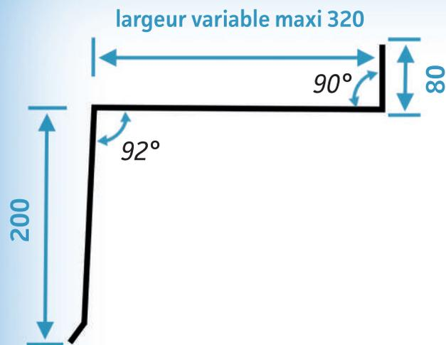
Réalisé en tôle 1<sup>er</sup> choix galvanisée et laquée à 25µ
