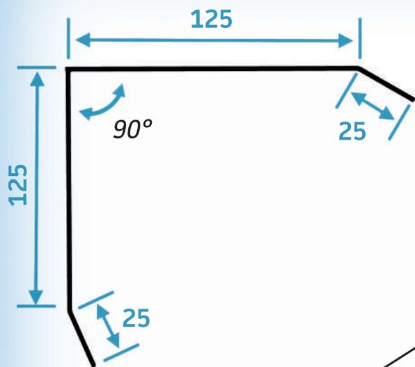
Réalisé en tôle 1<sup>er</sup> choix galvanisée et laquée à 25µ
