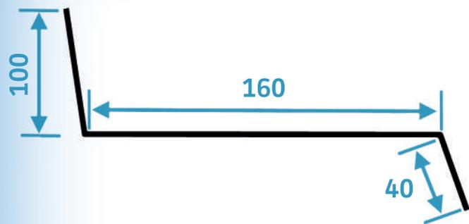
Réalisée en tôle 1<sup>er</sup> choix galvanisée et laquée à 25µ
