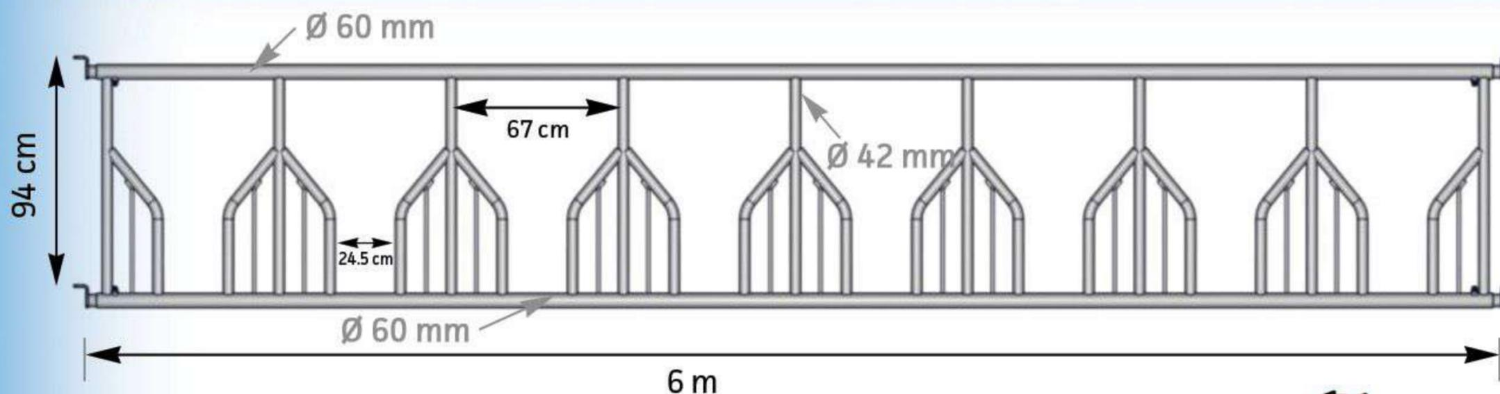
Panneau libre service FESTON de 8 places sur 6m permettant de limiter le gaspillage à l'auge. Convient aux bêtes encornées.
