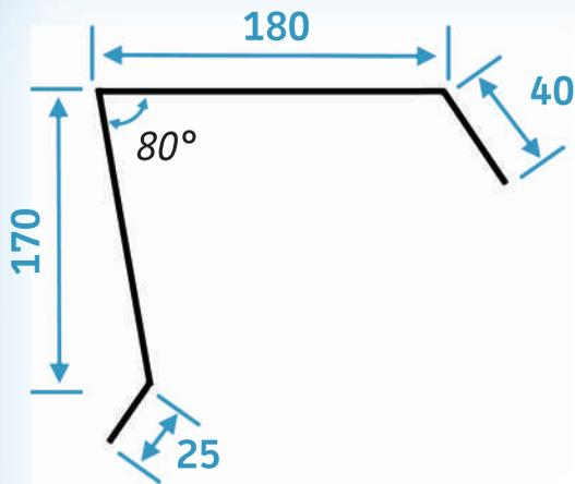
Réalisé en tôle 1<sup>er</sup> choix galvanisée et laquée à 25µ
