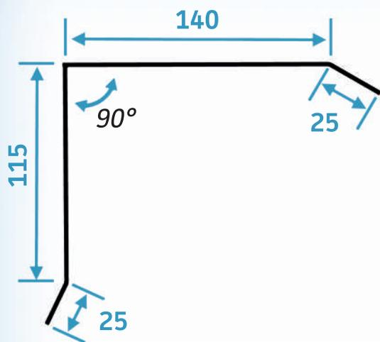
Réalisée en tôle 1<sup>er</sup> choix galvanisée et laquée à 25µ
